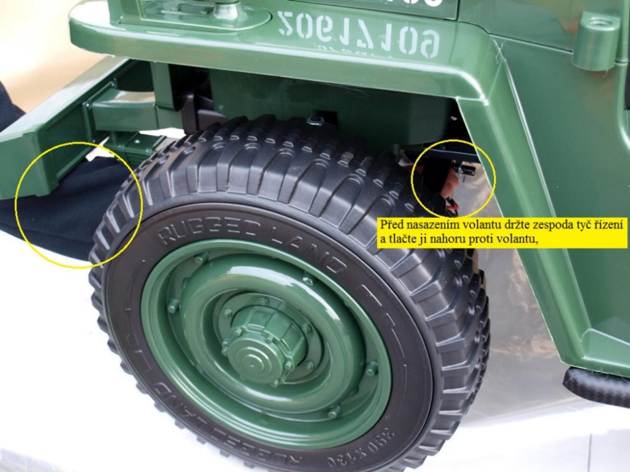
Před nasazením volantu držte zespoda tyč řízení
