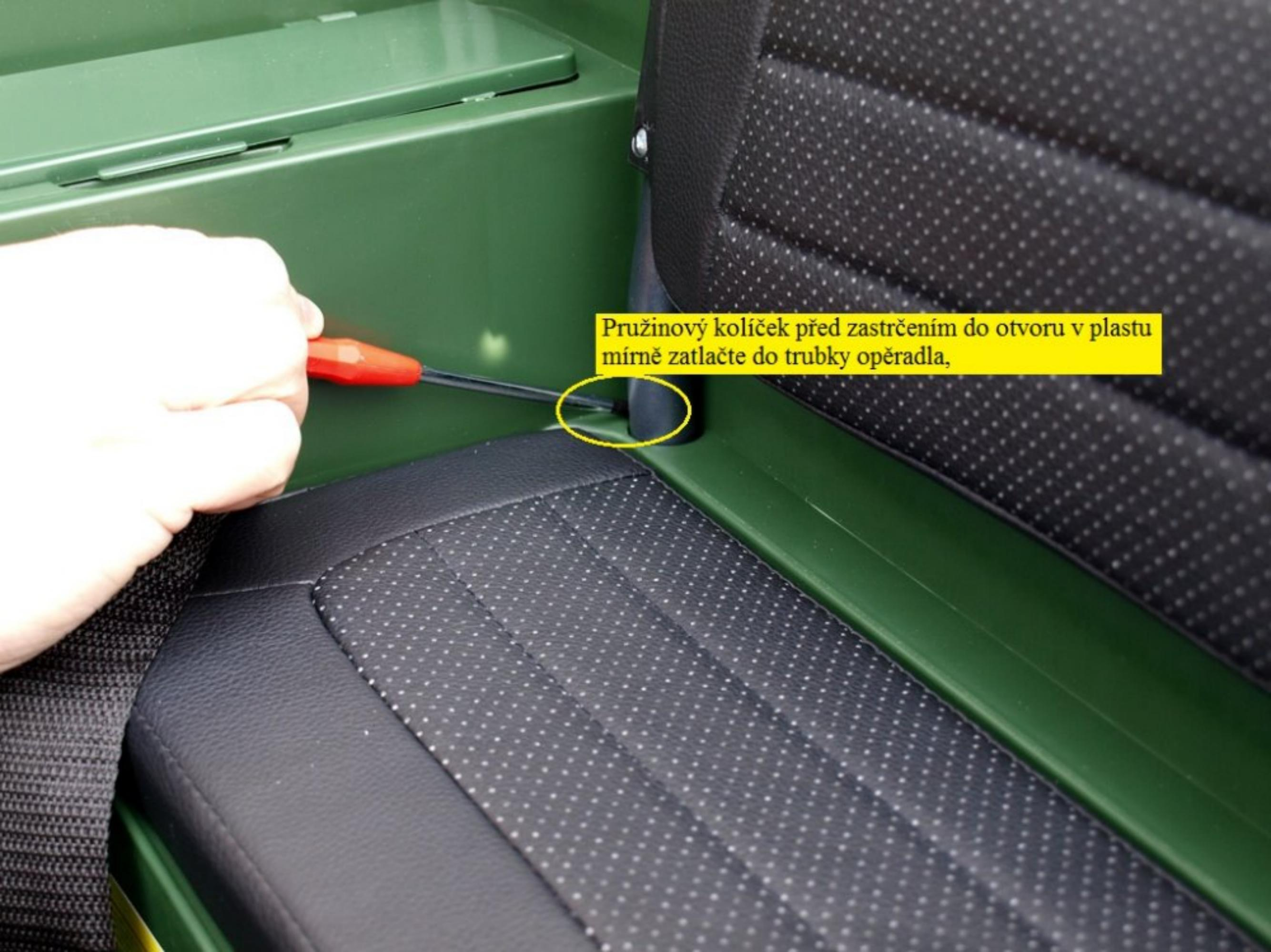
Pružinový količek před zastrčením do otvoru v plastu mírně zatlačte do trubky opěradla,
