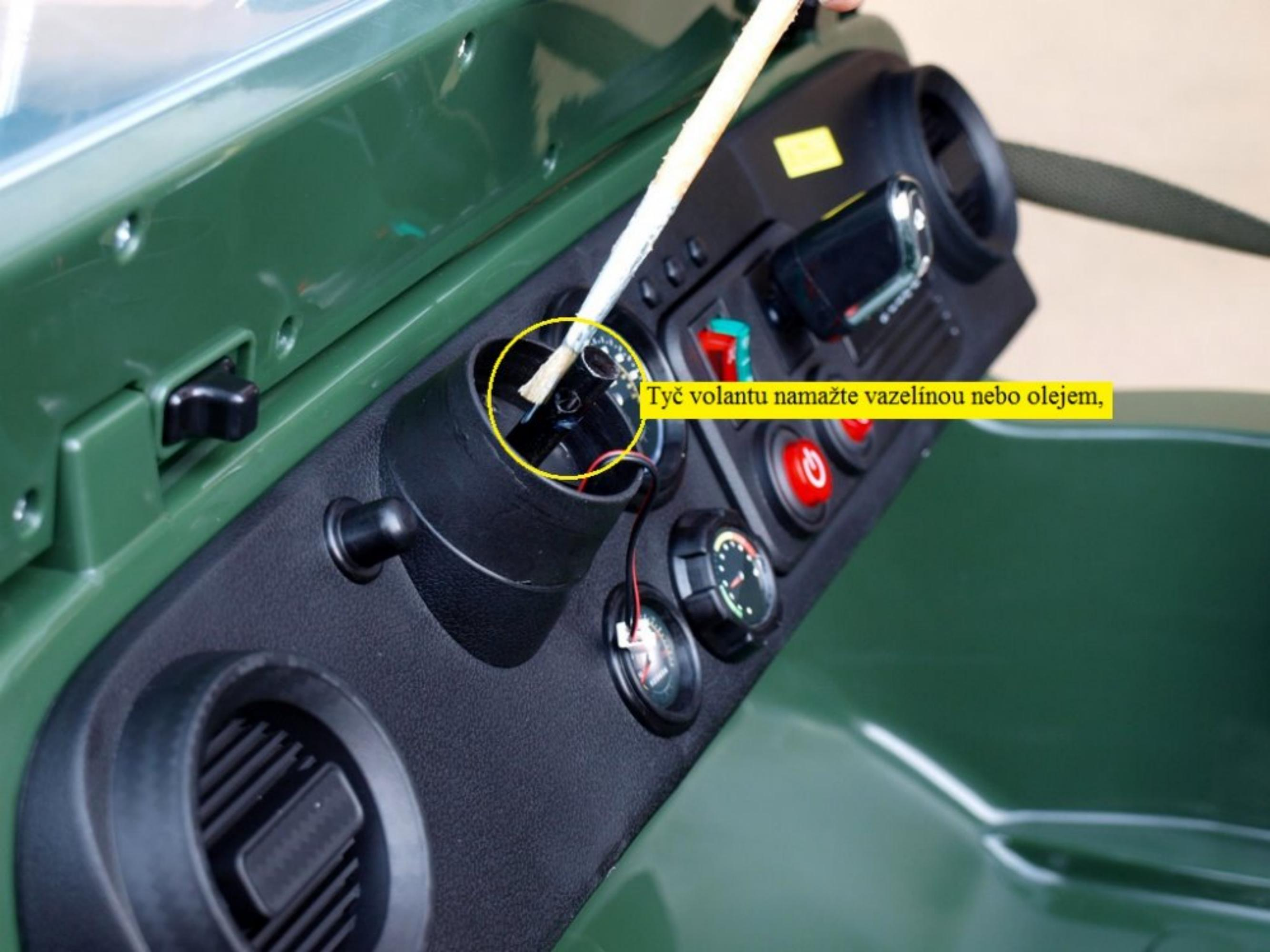
Tyč volantu namažte vazelinou nebo olejem,
