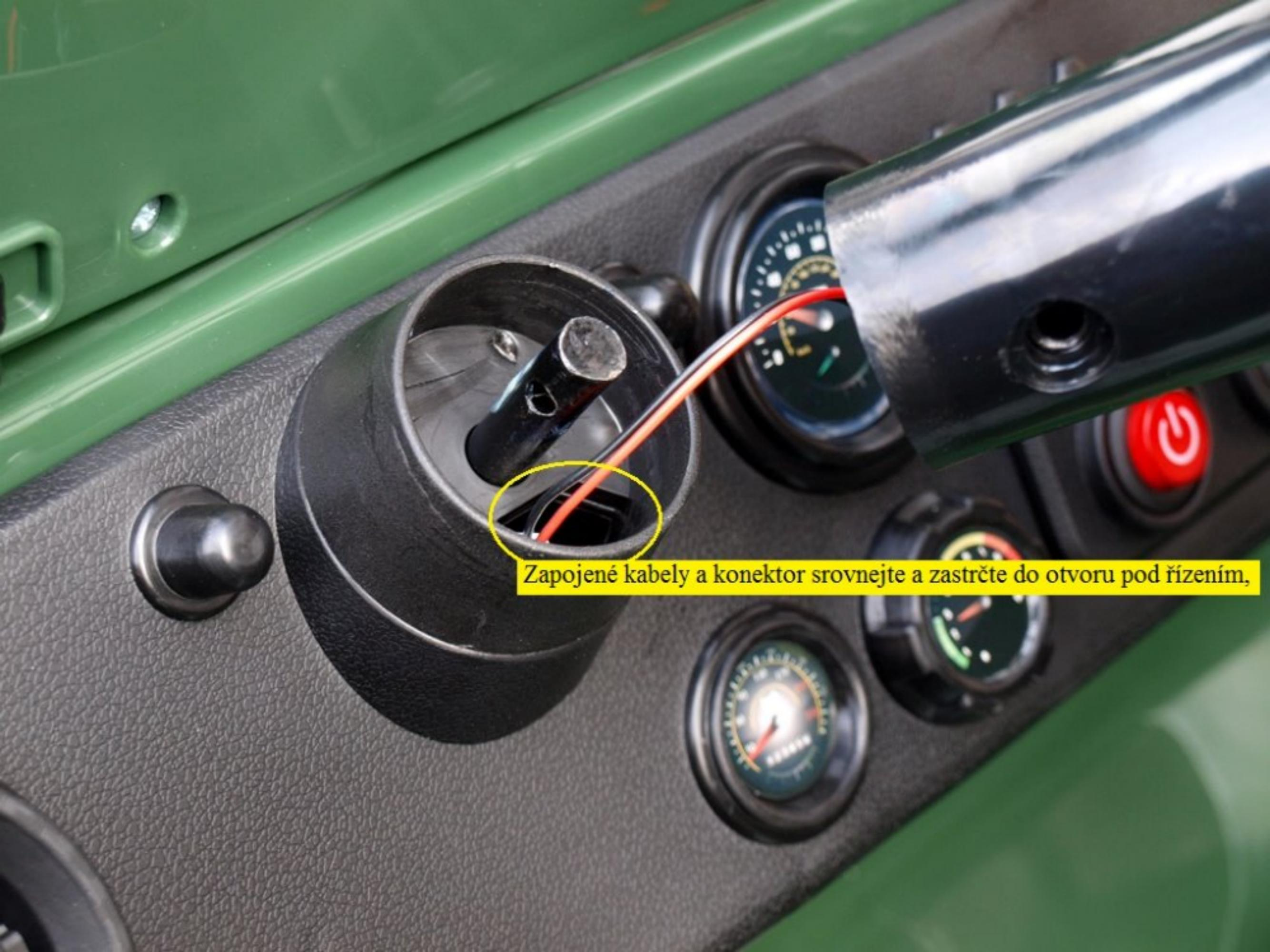
Zapojené kably a konektor srovnejte a zastrčte do otvoru pod řízením,
