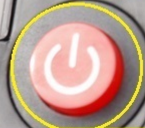
Hlavní vypínač: zatlačením zapni, zatlačením zpět vypni,
