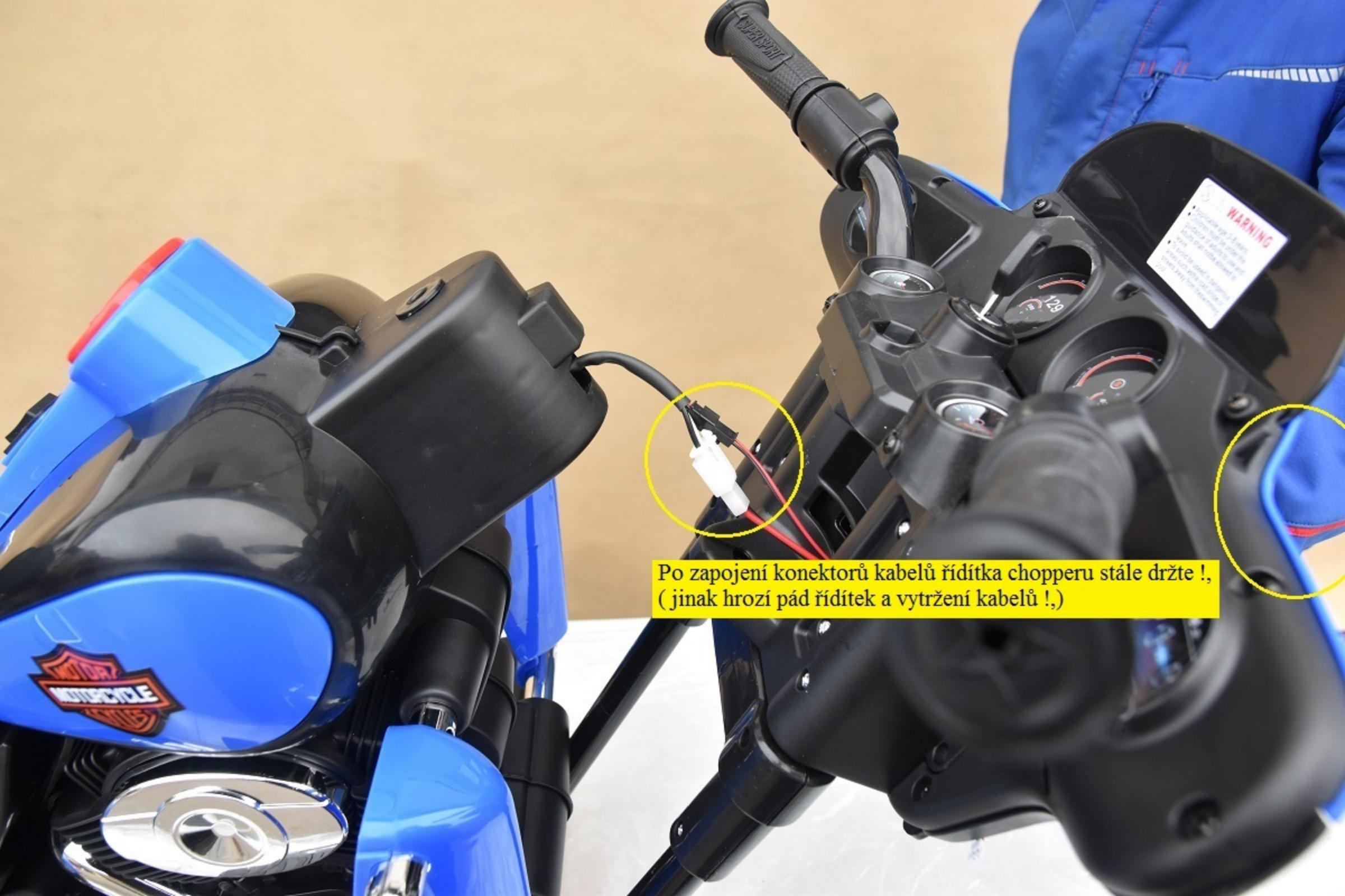
Po zapojení konektorů kabelů řídítka chopperu stále držte !,
