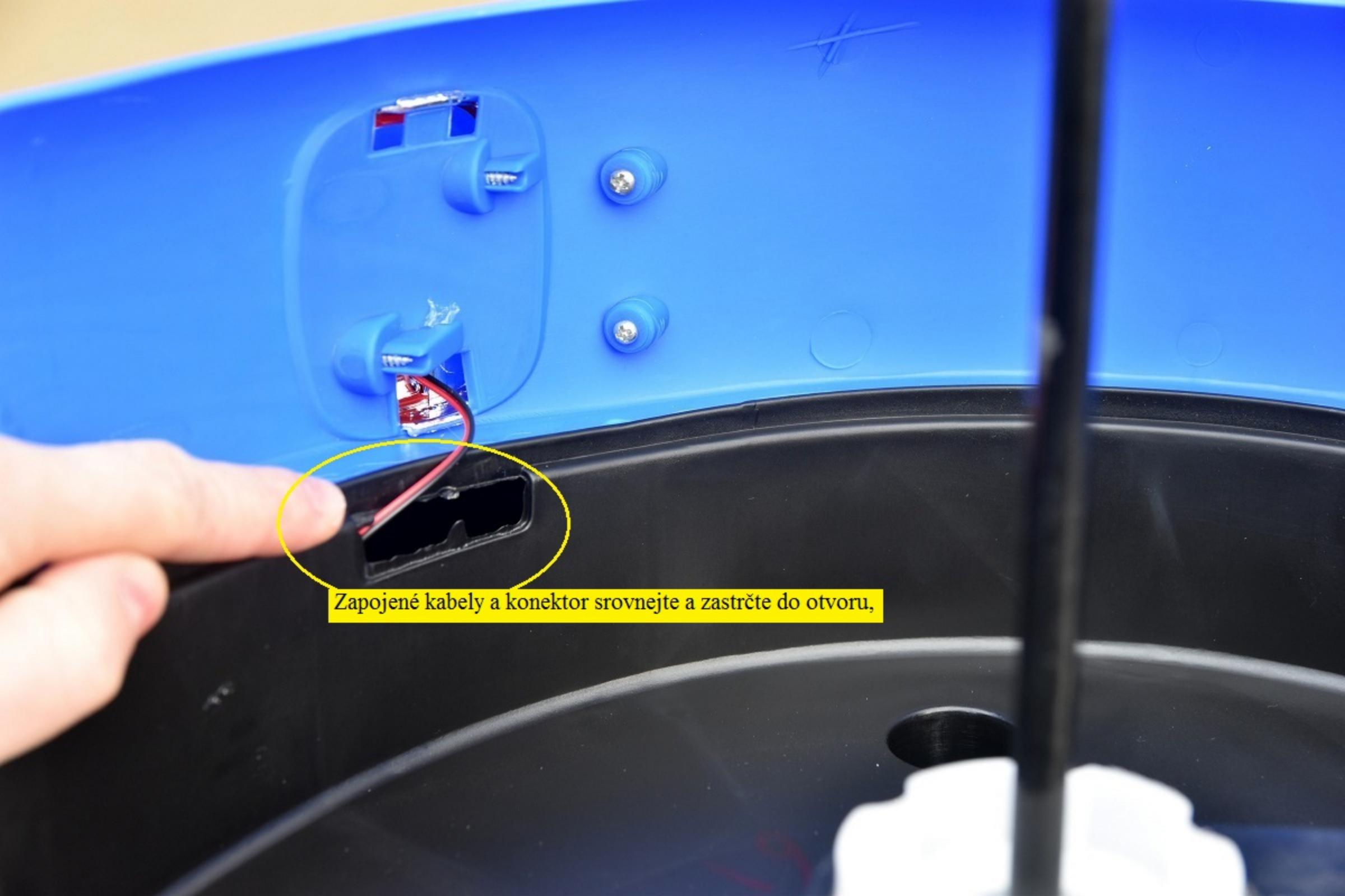
Zapojené kably a konektor srovnejte a zastrčte do otvoru,
