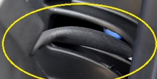
Zapojené kably a konektor srovnejte a zastrčte do otvoru,
