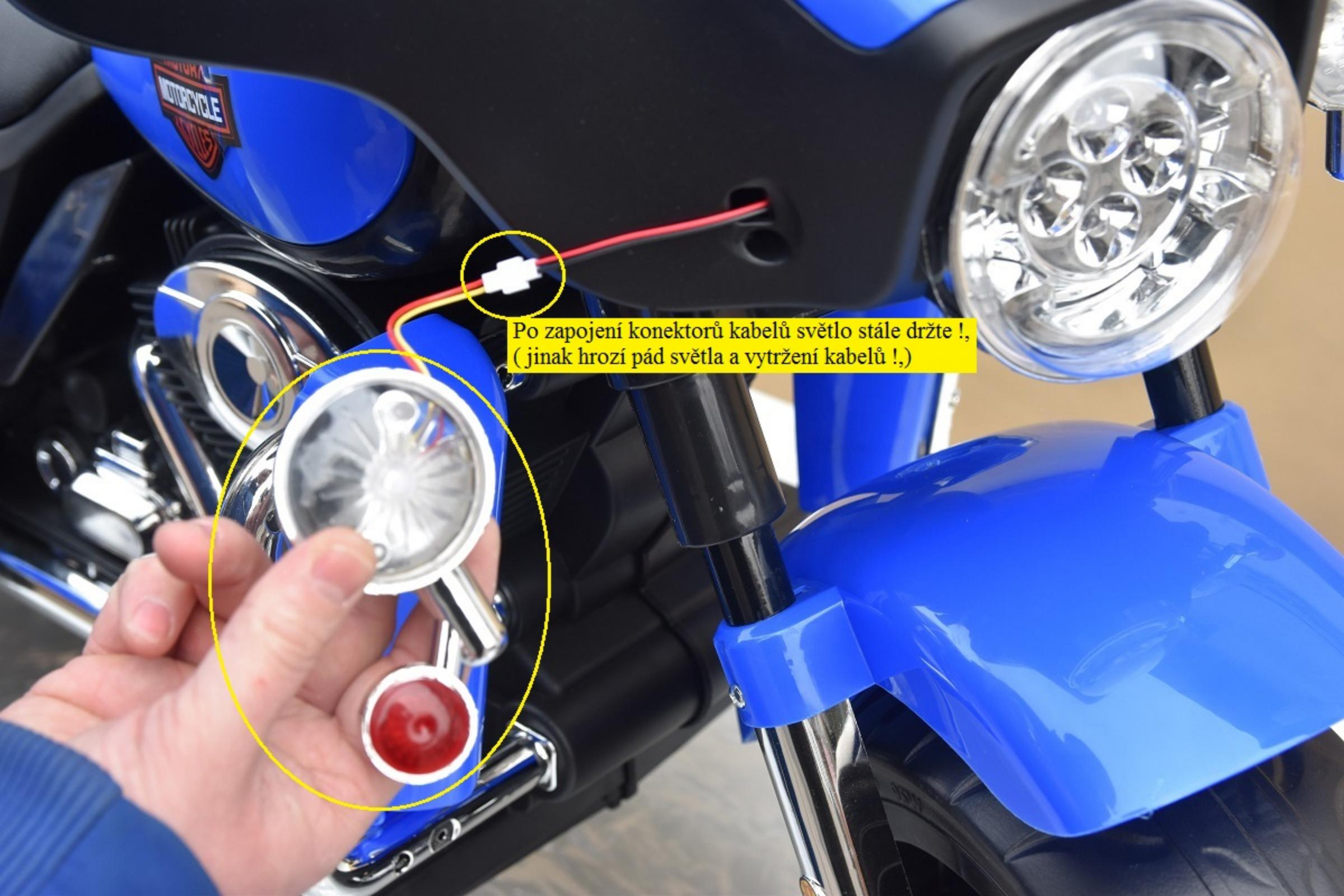
Po zapojení konektorů kabelů světlo stále držte !,
