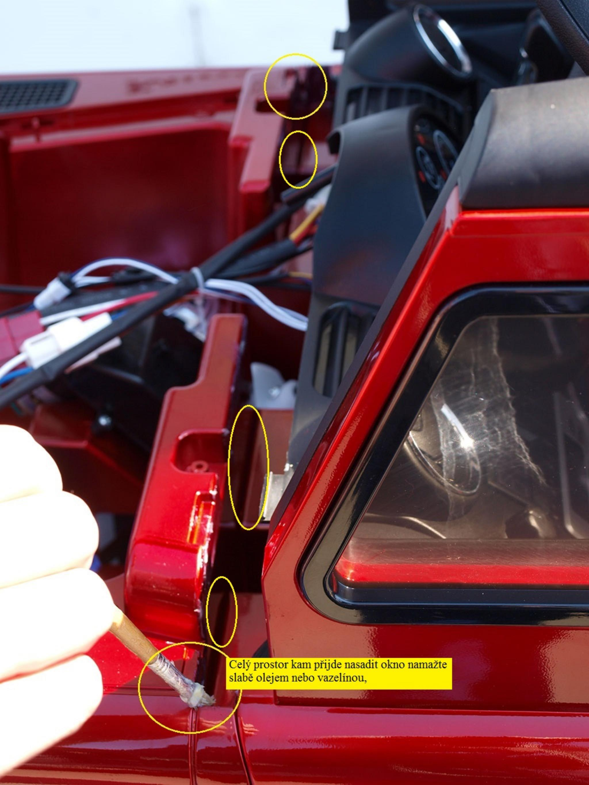
Celý prostor kam příde nasadit okno namažte slabě olejem nebo vazelinou,
