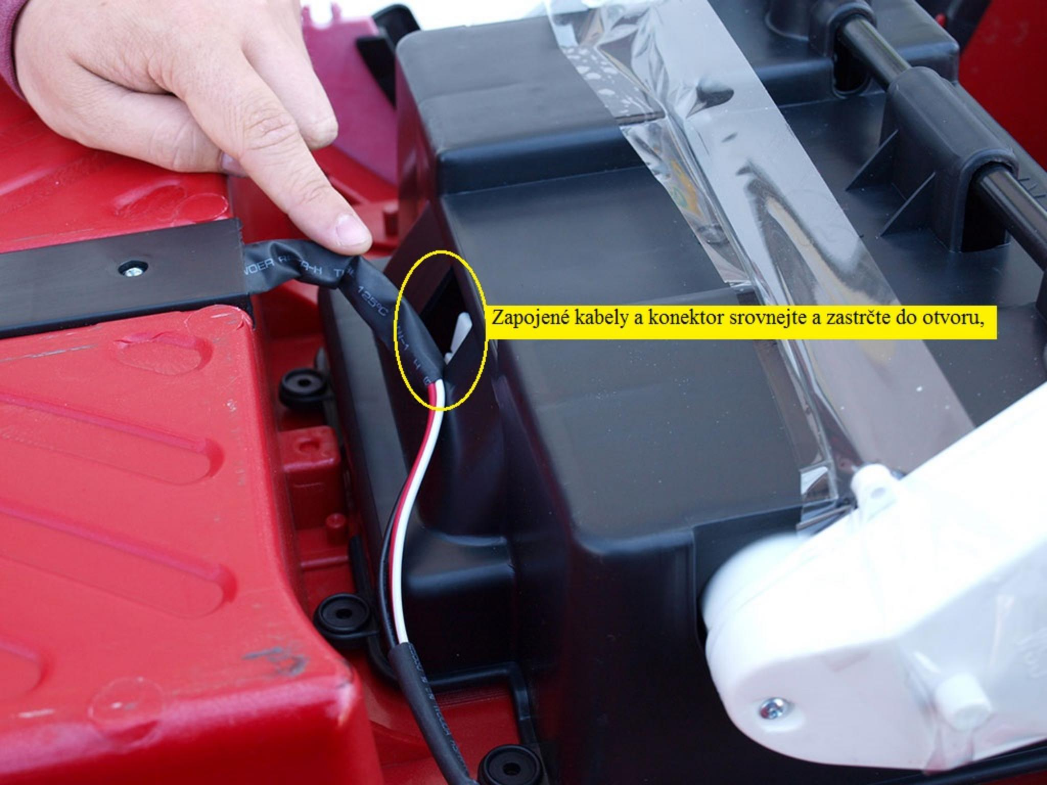
Zapojené kably a konektor srovnejte a zastrčte do otvoru,
