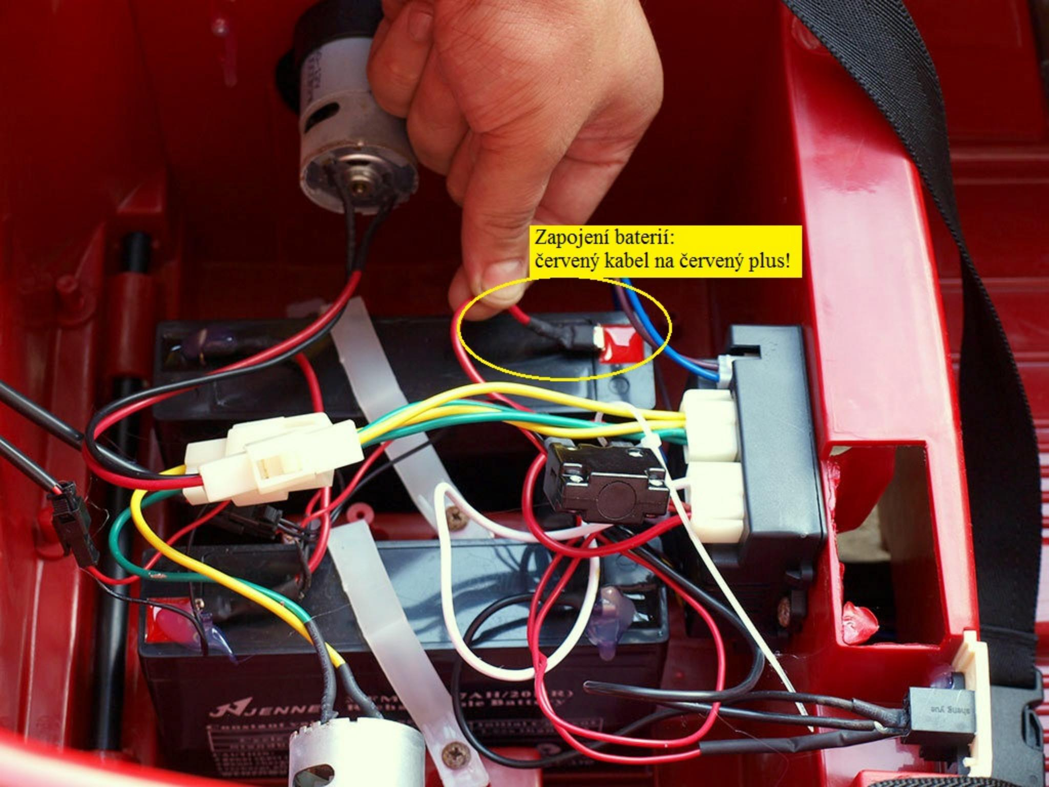
Překontrolujte zapojení baterií přesně podle obrázku,
