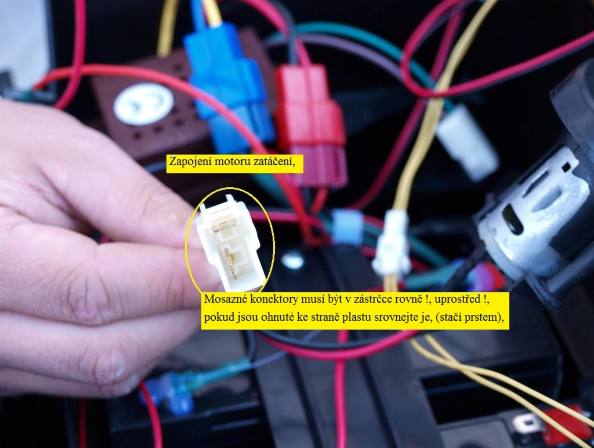
Zapojení motoru zatáčení,
